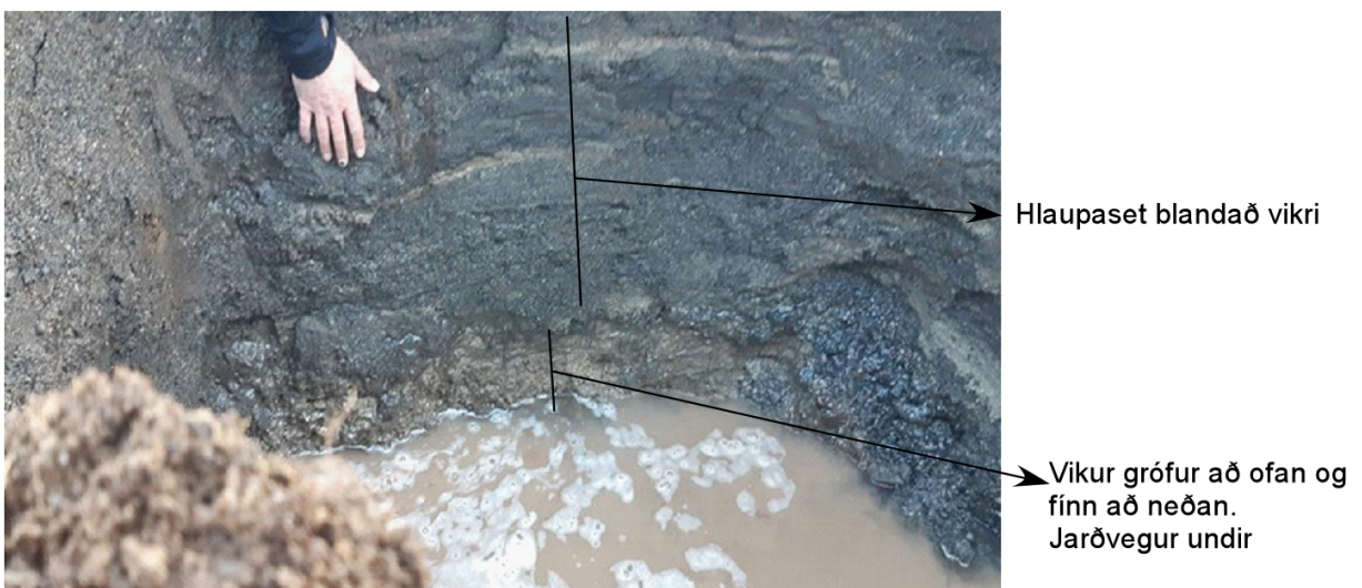
Mynd 13. Snið í holu 8. Sýnir að ofan á gjóskunni frá 1362 er jökulhlaupaset blandað af gjósku frá 1362. Í botni holunnar gefur að líta grófa vikurlagið frá 1362. Undir vikurlaginu er fínt lag sem myndaðist í upphafi eldgoss, sem einkennir allt svæðið. Þegar fína lagið var rofið streymdi upp grunnvatn í holuna.
